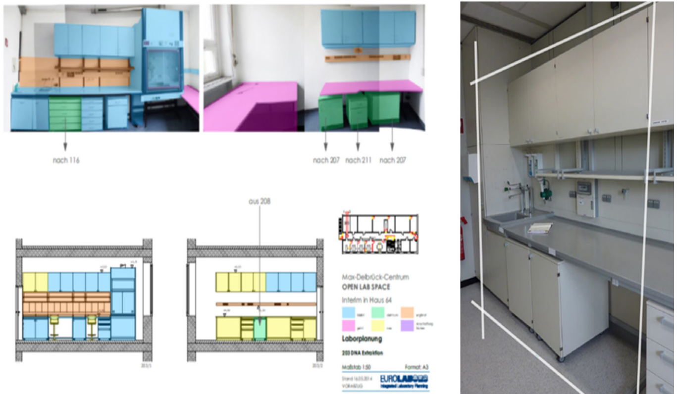
Abb. 3: Sanierung Haus 64; Beispiel für die Kartierung der Laboreinrichtung (links); Beispiel für eine ersteigerte Laboreinrichtung (rechts)
